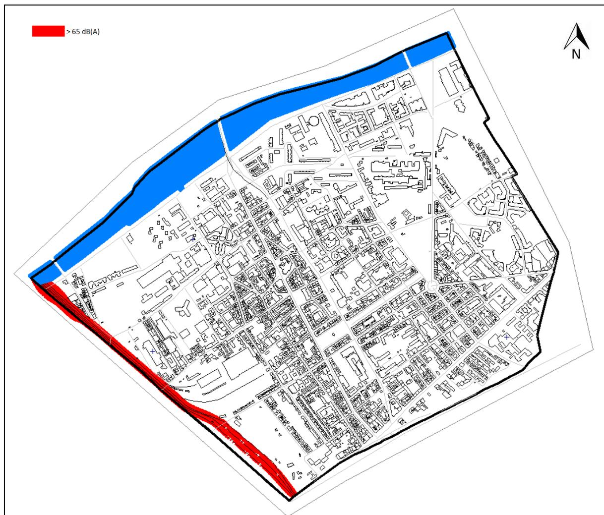
Figure 11 : Zone de dépassement de l'indice sonore pour le bruit ferroviaire – L<sub>n</sub>
