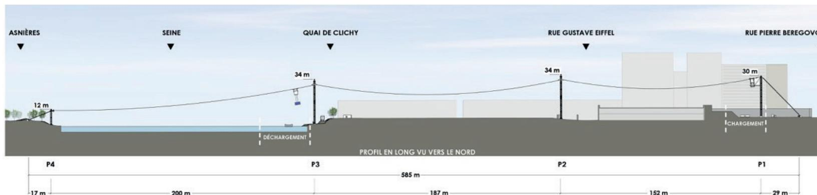
**1<sup>er</sup> KM à câble - Transfert aérien des déblais par téléphérique** - Idée originale et MOE S'PACE - Réalisation MÉCAMONT HYDRO
